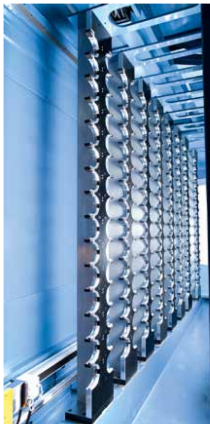
3 Das Matsuura-H.Plus-Rack-Magazin wartet mit besonders schnellen Werkzeugbereitstellungszeiten auf (Bild: Matsuura)
